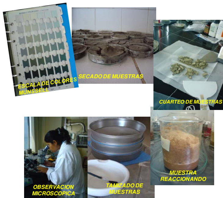
Figura. 78 Procedimiento para la Determinación Granulométrica de Sedimentos en el Laboratorio de IMARPE - Pisco. Determinación de Bases Técnicas para el Ordenamiento Pesquero y Acuícola de la Bahía Paracas.
