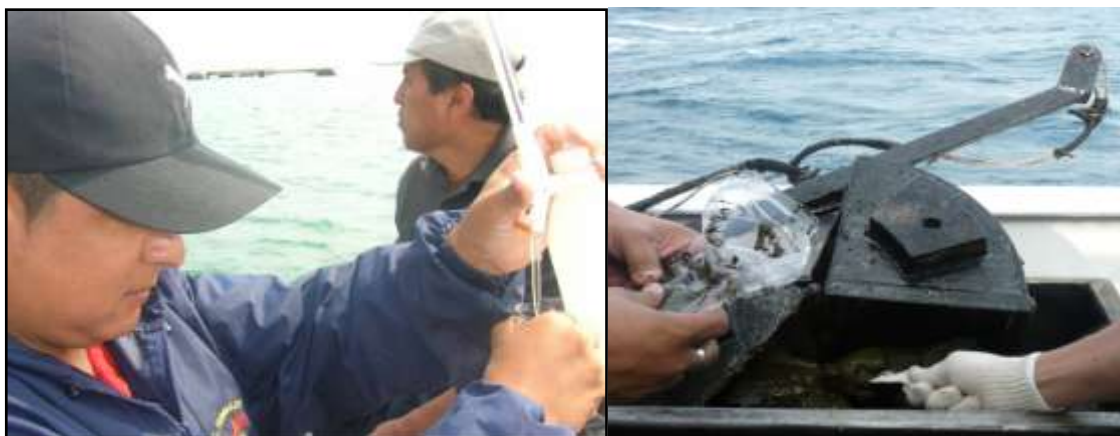
Figura 3. (a) Determinación del oxígeno disuelto en el agua de mar por el método de Winkler (Foto cortesía de M. Sarmiento) (b) colecta de sedimentos del fondo de mar mediante el uso de la draga Vann Veen (Fotos cortesía de E. Fernández).
