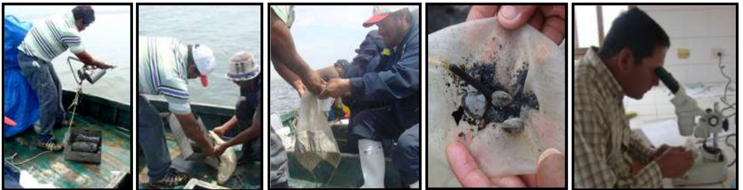
Anexo 7.-Draga Vaan Veen, obtención de la muestra de sedimentos y análisis microscópico Delimitación de Bancos naturales y zona de pesca Artesanal. Punta Literas – Playa Grande (La Choza) 2009
